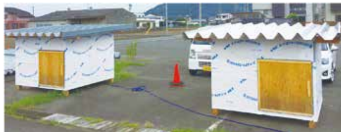
左が折板屋根そのまま、右がサーモバリア施工
